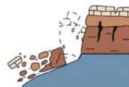
Eboulement ou basculement de blocs
